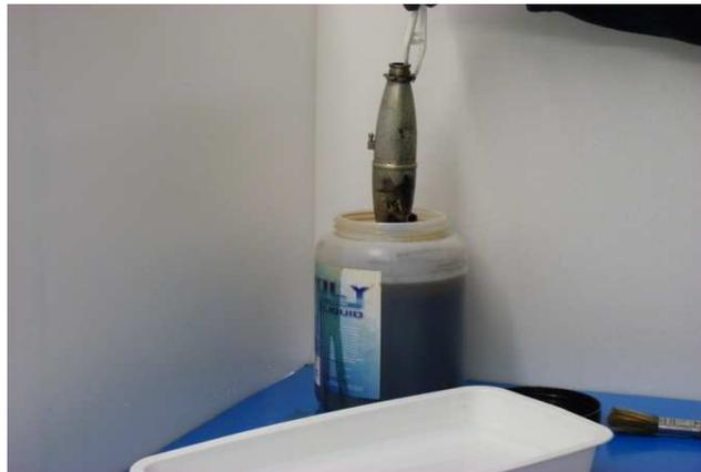
*Mettre le résonateur dans le bac de rinçage avec de l'eau tiède.*
